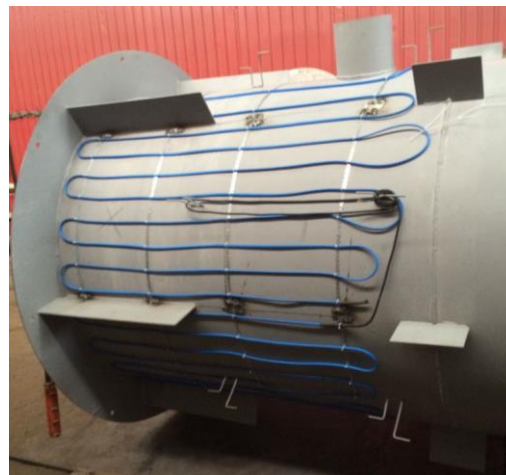
Рис.2. Схема и изображение обогреваемой емкости для приготовления топлива с депрессорной присадкой. 1 – емкость; 2 – насос; Поток: I – присадка; II – топливо; III – топливо с присадкой
